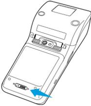
**7** Poussez le verrou au bas du terminal vers la gauche pour verrouiller le couvercle de la batterie.
