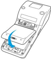
**6** Remettez le couvercle du compartiment batterie en place en faisant cliquer tout d'abord la partie supérieure puis la partie inférieure. Vous évitez ainsi de casser les extrémités supérieures et que le couvercle ne recouvre pas correctement l'appareil.
